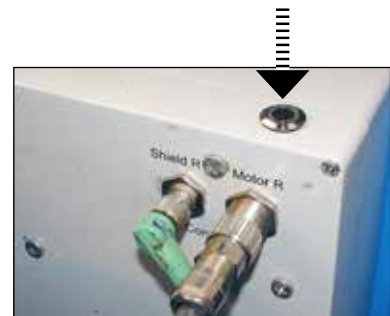
▲ 24/3 Taster Ein/Aus an der Steuerung
