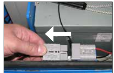
▲ 11/1 Steckverbindung Akkus <> Steuerung trennen
