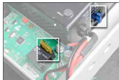
▲ 43/3 Sicherungen Ladegerät Pribot
