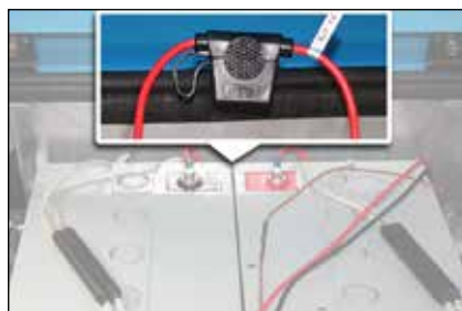
▲ 43/1 Sicherung Pribot-Gehäuse
