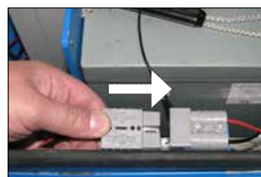
▲ 14/2 Spannungsversorgung mit der Steuerung herstellen
